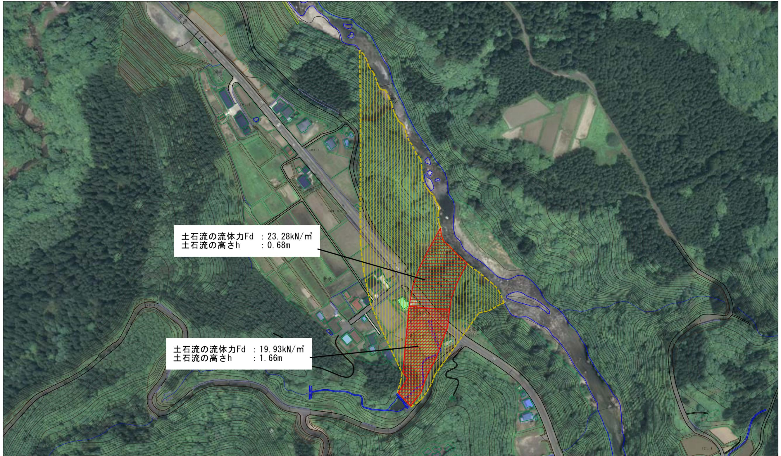
土石流の流体力Fd : 23.28kN/m<sup>2</sup>
