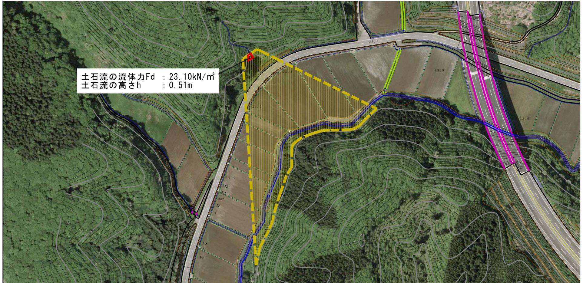
土石流の流体力Fd : 23.10kN/m<sup>2</sup>
