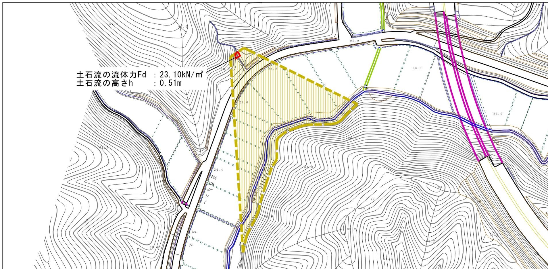
土石流の流体力Fd : 23.10kN/m<sup>2</sup>
