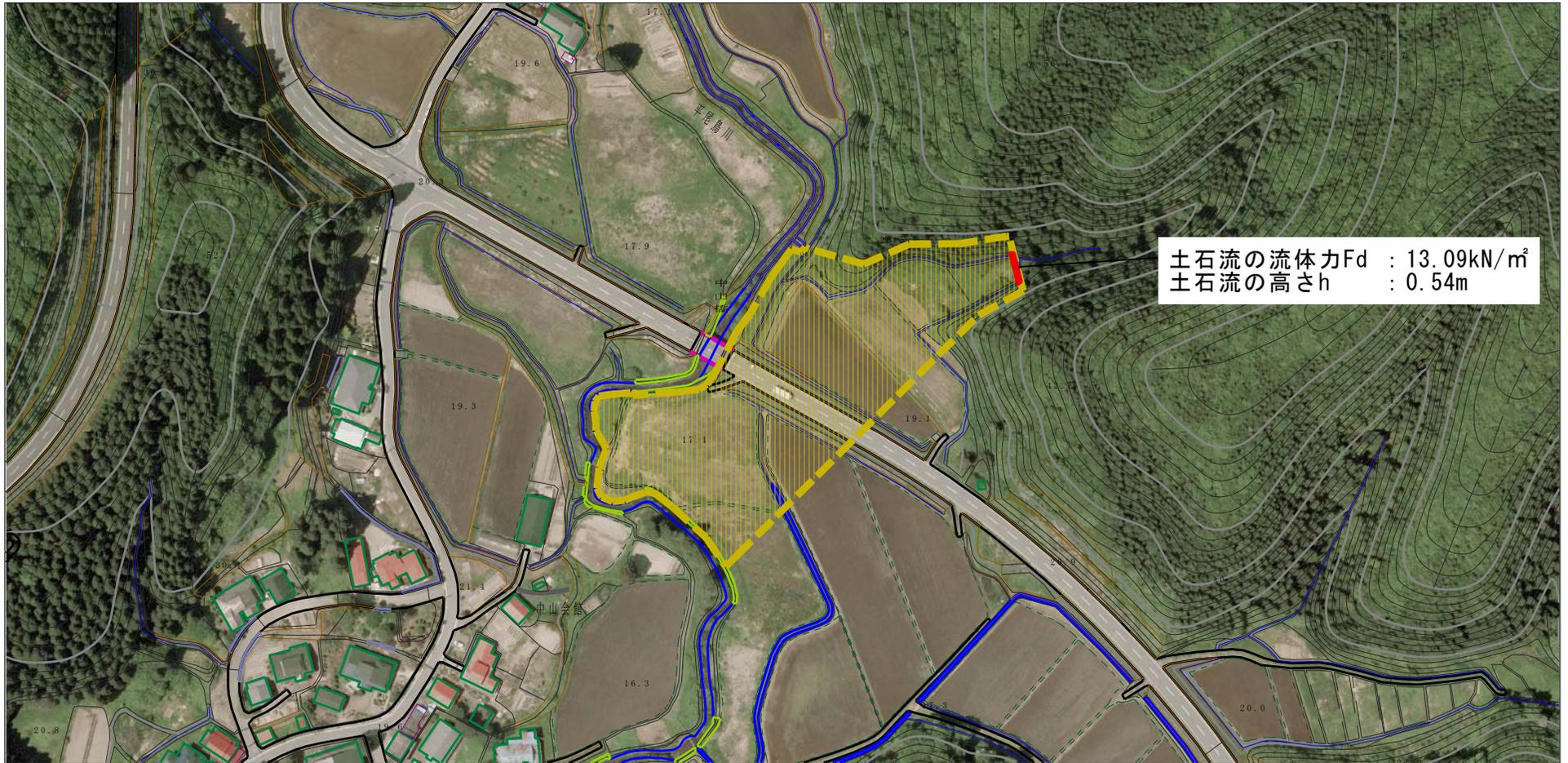
土石流の流体力 $F_d$  : 13.09kN/m<sup>2</sup>
